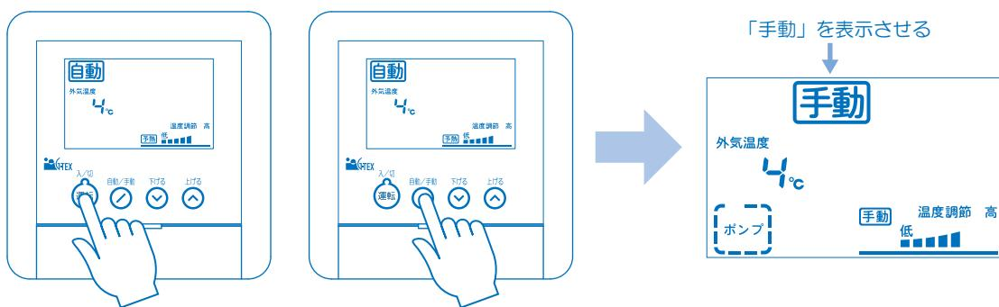
2. 手動運転の設定をしてください。温度設定スイッチ「上げる」「下げる」で上下し、希望のバー表示の目盛に設定します。
