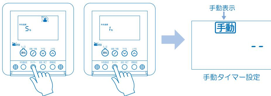
3. 現在、設定されている時間が表示されます。設定を変更しない場合は、設定 / 終了スイッチを押すと元の画面に戻ります。（20秒以上スイッチ操作がないときも同様）（ブザーが鳴ります）
