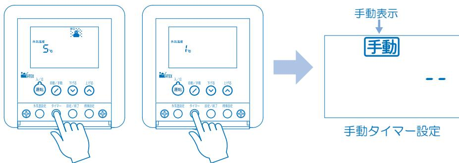
3. 現在、設定されている時間が表示されます。設定を変更しない場合は、設定 / 終了スイッチを押すと元の画面に戻ります。（20秒以上スイッチ操作がないときも同様）
