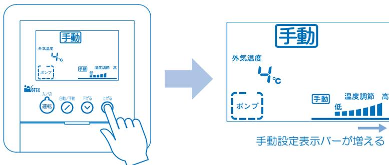
②温度設定スイッチ「下げる」を押すと、手動設定表示バーが減ります。
