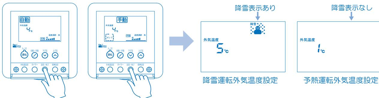
2. 予熱運転外気温設定表示（降雪表示なし）のときは、外気温設定スイッチを押して降雪運転外気温設定表示（降雪表示あり）にします。
