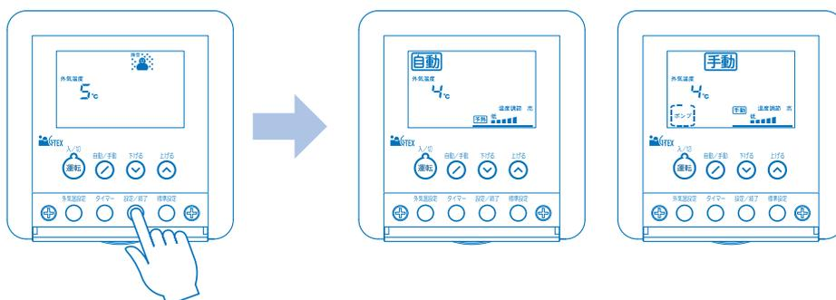
4. 設定を変更する場合は、温度設定スイッチを押すことで、1°C毎に-5°C～10°Cの範囲で設定できます。
