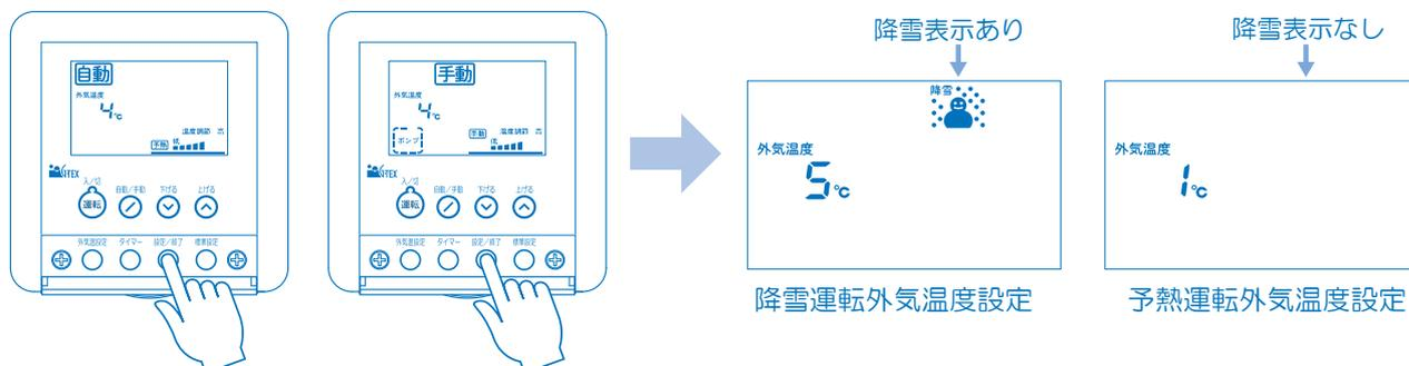
2. 降雪運転外気温度設定表示（降雪表示あり）のときは、外気温度設定スイッチを押して予熱運転外気温度設定表示（降雪表示なし）にします。
