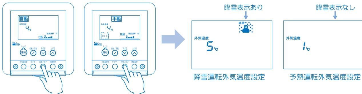
2. タイマー設定スイッチを押して手動タイマー設定表示にします。
