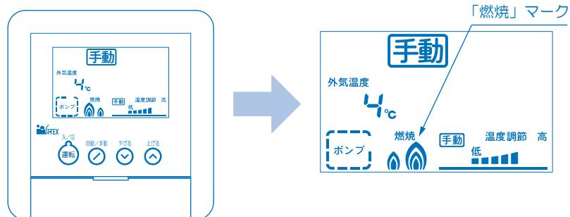
**手動設定温度の目安（機器の出湯温度）**
