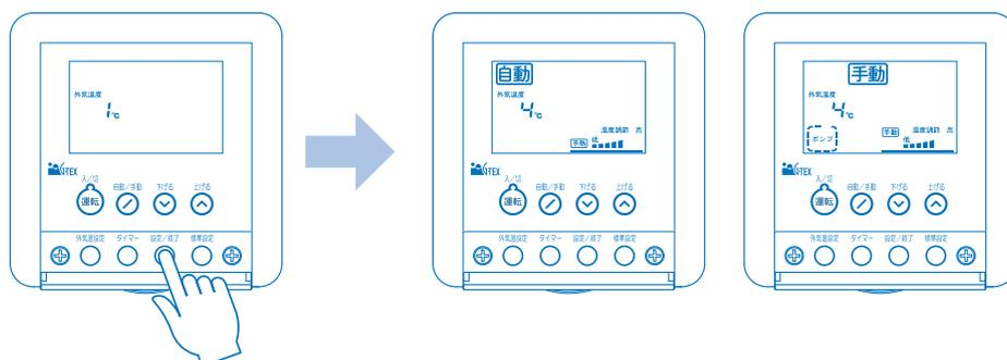
4. 設定を変更する場合は、温度設定スイッチを押すことで、1°C毎に-5°C～10°Cの範囲で設定できます。
