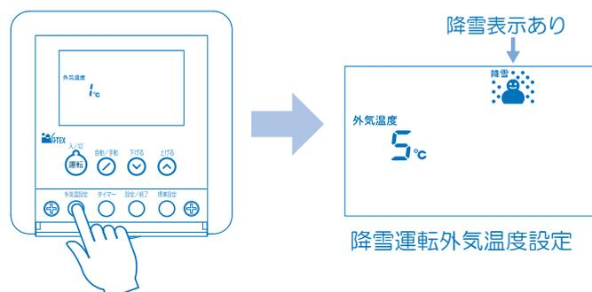
3. 現在、設定されている温度が表示されます。設定を変更しない場合は、設定 / 終了スイッチを押すと元の画面に戻ります。（20秒以上スイッチ操作がないときも同様）（ブザーが鳴ります）
