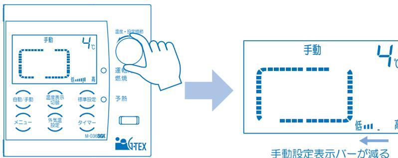
③手動設定の温度により、機器が燃焼を始め、リモコン画面に「運転 / 燃焼」ランプが赤色点灯します。
