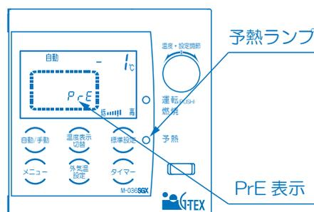
②外気温度が設定値より下がると、予熱設定温度により、運転 / 燃焼ランプが赤色点灯、ポンプ運転表示が点滅します。
